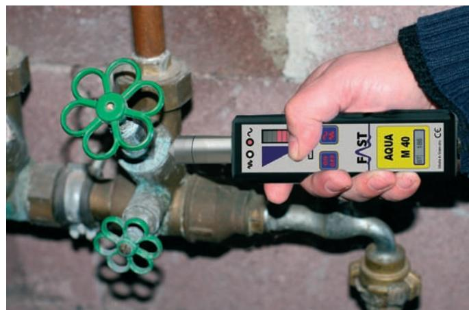
Zum Messen wird das Aqua M-40 entweder mit dem im Lieferumfang befindlichen Zubehör, oder direkt mit der Messspitze auf die zu prüfende Leitung bzw. Armatur gesetzt. Befindet sich ein Rohrbruch auf dieser Leitung, so wird das Leckgeräusch an dieser Stelle hörbar sein. Die integrierte Pegelanzeige gibt einen Hinweis auf die Intensität des aufgenommenen Leckgeräusches.
